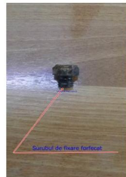
Fig.8 Șurubul de fixare al manșonului de legătură, poz.19, Fig.5
