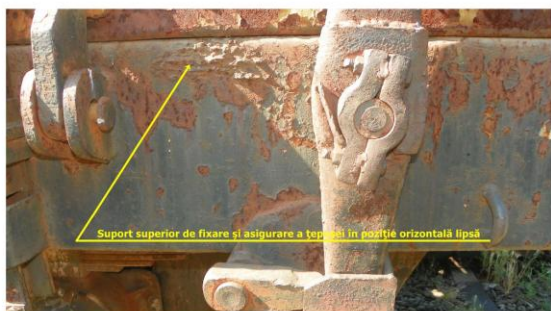
Fig. 5 Suport superior de fixare și asigurare a țepușei în poziție orizontală – lipsă
