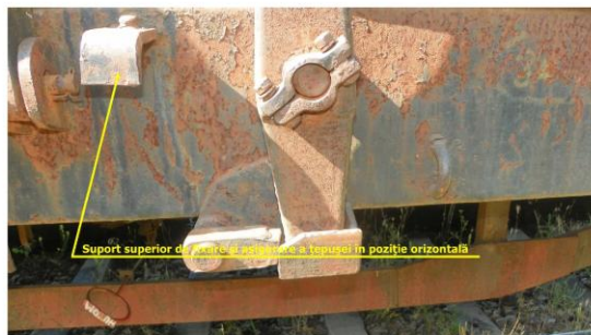
Fig. 6 Suport superior de fixare și asigurare a țepușei în poziție orizontală
