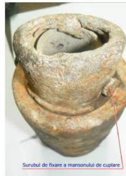
Fig.7 Corpul carterului regulatorului de timonerie SAB tip FE, poz.8, Fig.5
